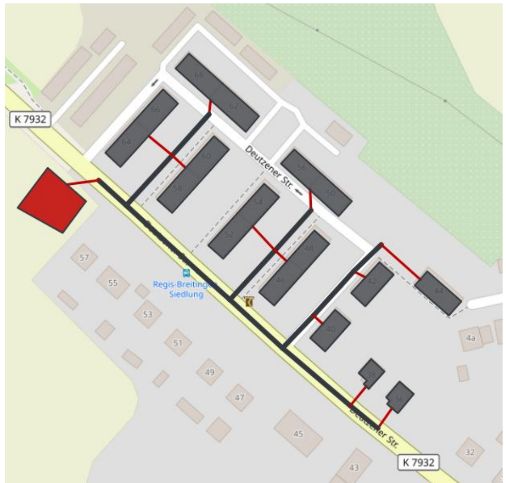
Abbildung 48 Definierter Trassenverlauf der Versorgungsvariante 1 „Wärmenetz“
