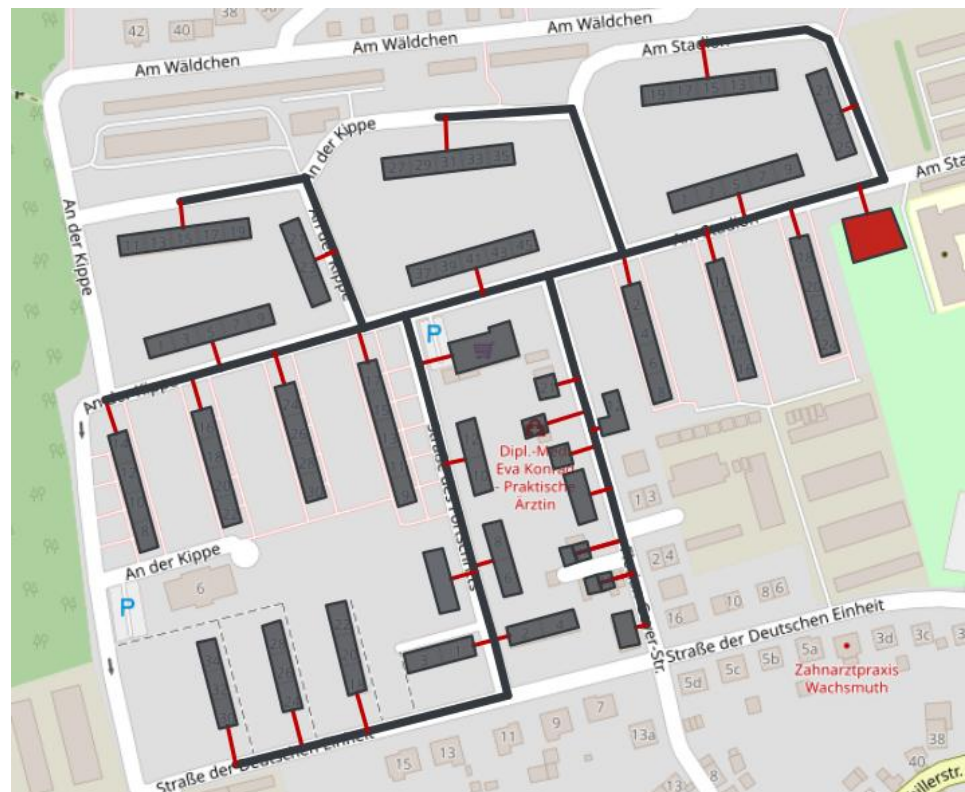
Abbildung 42 Definierter Trassenverlauf der Versorgungsvariante 1 „Wärmenetz“
