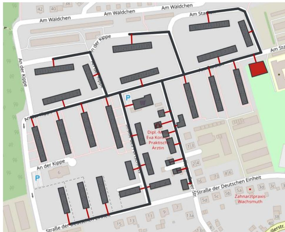
Abbildung 42 Definierter Trassenverlauf der Versorgungsvariante 1 „Wärmenetz“
