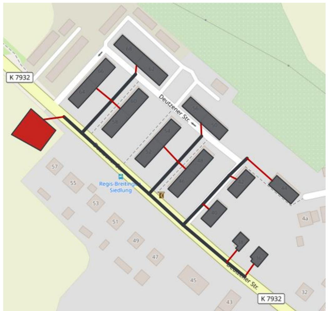
Abbildung 48 Definierter Trassenverlauf der Versorgungsvariante 1 „Wärmenetz“
